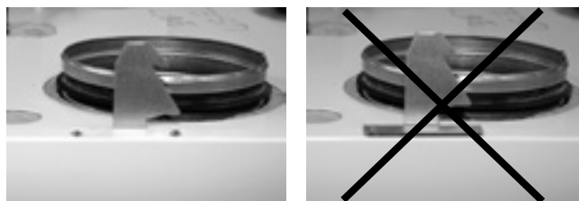
Krokarnas spetsar pekar mot aggregatets bakre del och de träs in i aggregatets urtag före nitningen.
