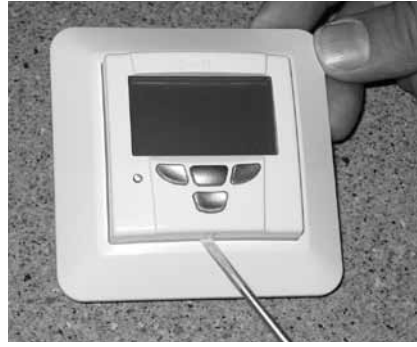
Premium-ohjauspaneelin etupaneelin irrottaminen.
