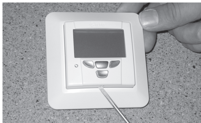
Premium-ohjauspaneelin etupaneelin irrottaminen
