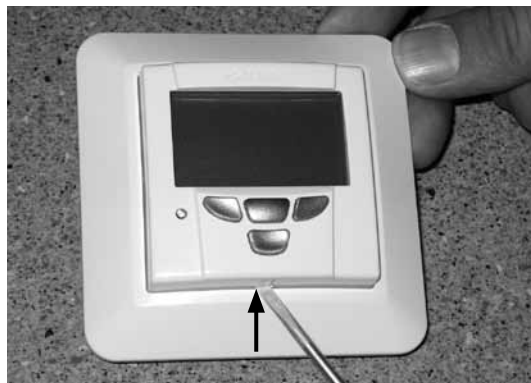
Borttagning av panel från ILTO Premium styrenhet.
