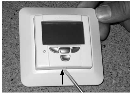
Paneelin irrottaminen ILTO Premium -säätimestä.
