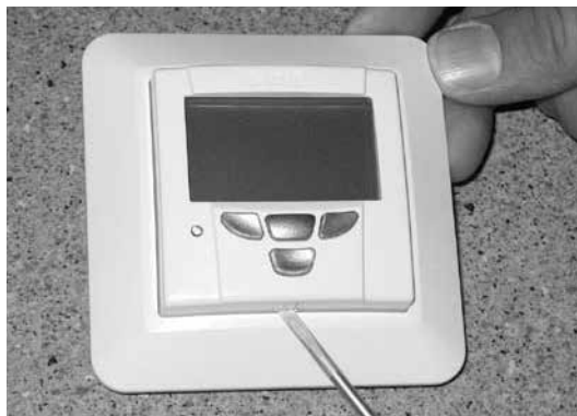
Paneelin irrottaminen Premium-säätimestä.
