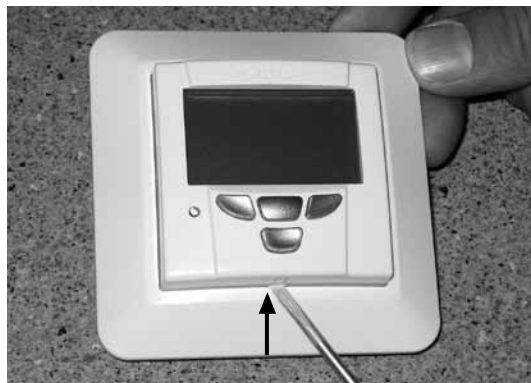
Borttagning av panel från ILTO Premium styrenhet.
